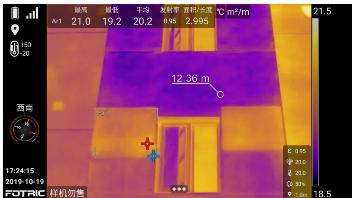
要测量面积，需要在屏幕上添加一个测温方框或圆圈。热像仪将根据目标的距离计算测温方框或圆圈的面积。激光测距仪打开时，在被测目标上可以看到一个激光点。激光测距仪测量到该目标的距离。热像仪假设此距离整个测量方框或圆圈有效。
