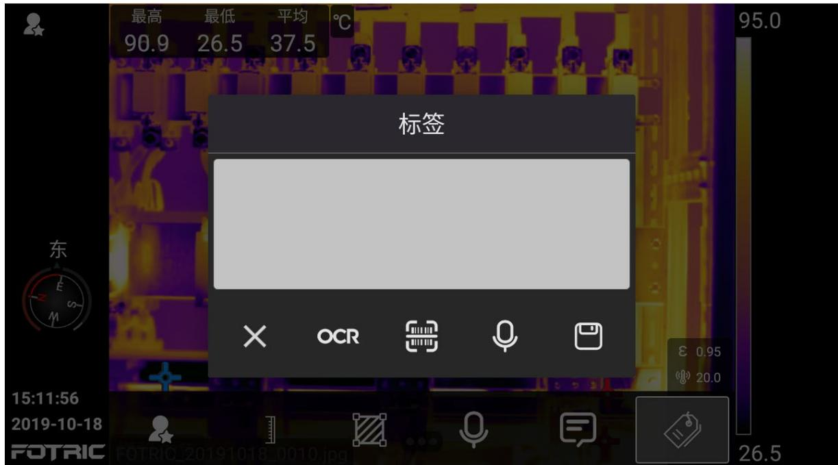
可在热像拍照冻结后通过二维码扫描、HawkAI 文本识别、HawkAI 语音输入和手动键盘输入的方式实现标签自动命名功能。
