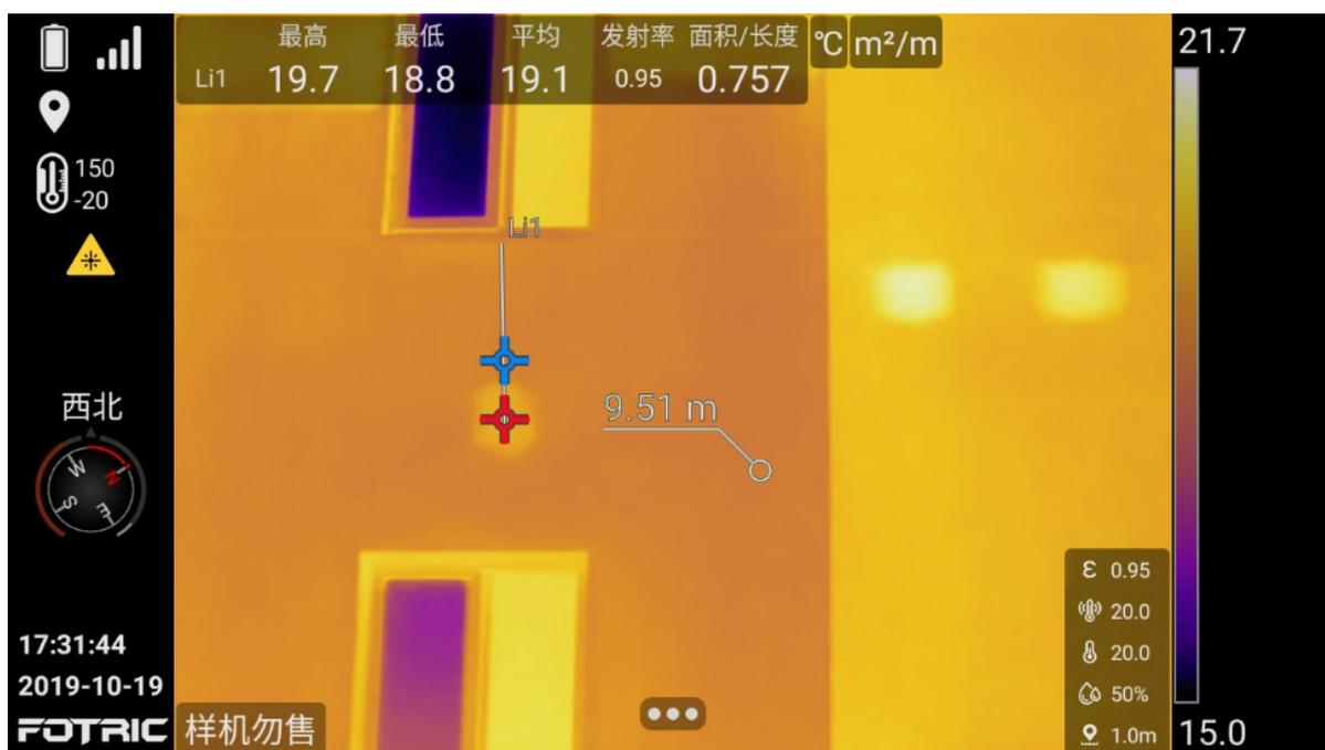
要测量长度，需要在屏幕上添加一个测温线。热像仪将根据到目标的测量距离计算测温线的长度。激光测距仪打开时，在被测目标上可以看到一个激光点。激光测距仪测量到该目标的距离。
