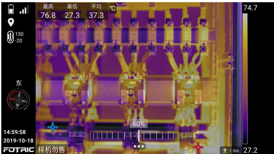
通过下方滑轮可以调整热像画面透明度，全透明时可直接在可见光上显示测温标识与温度数据。
