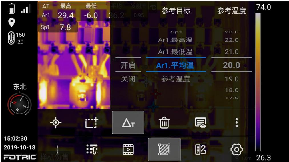
1. 计算测温标识之间温差，如所有温度数值的显示（除 Ar1 平均温）为实际温度减 Ar1 平均温；
