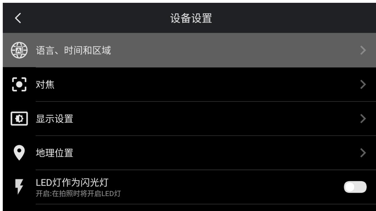
热像仪 LED 灯可以作为数码相机的闪光灯使用。如果启用了闪光灯功能，则在按下触发按钮保存图像时，热像仪 LED 灯将启用闪光灯功能。
