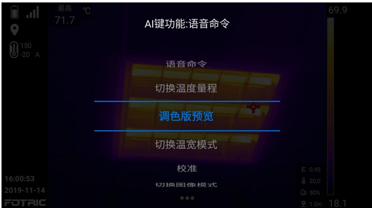
主界面 AI 键可设置内容：语音命令、切换温度量程、调色板预览、切换温宽模式、校准和切换图像模式。
