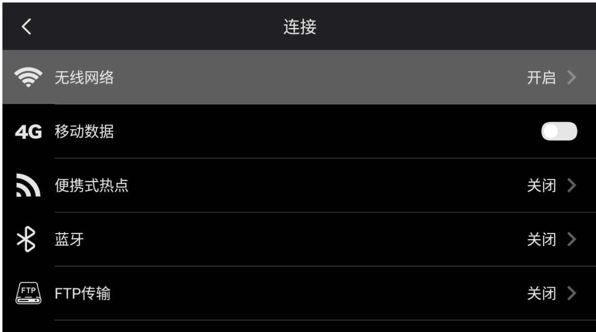
连接中可以设置无线网络连接、4G 开关、便携式热点设置、蓝牙连接和 FTP 传输。
