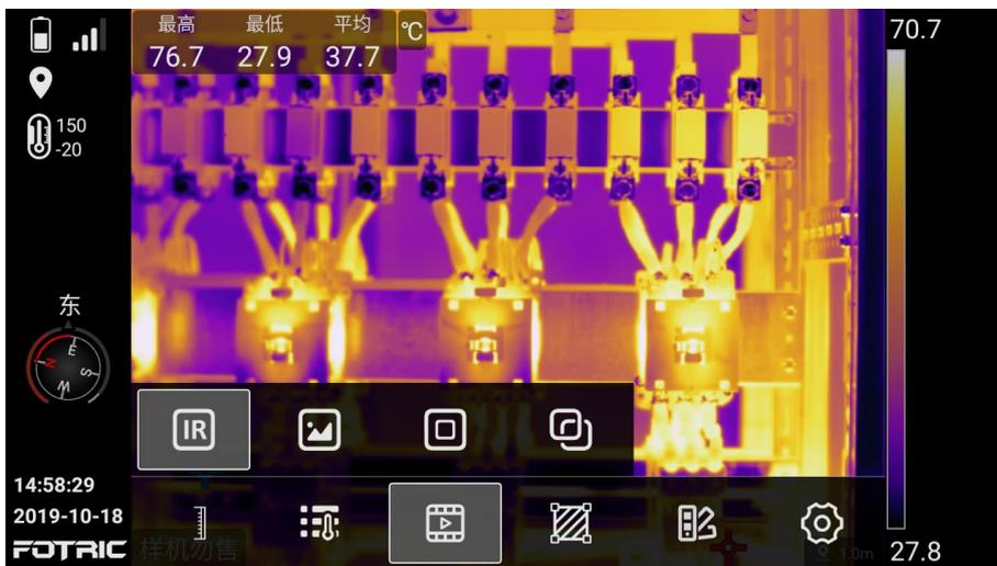
**！注意：**在热像模式下，请务必保证红外热像仪的准确对焦，若红外热像图没有清晰对焦，会影响热像仪的测温准确性。
