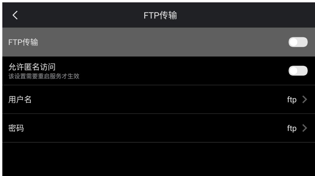
FTP 传输, 开启服务后, 可通过其它 FTP 客户端连接到热像仪, 进行 SD 卡文件传输。
