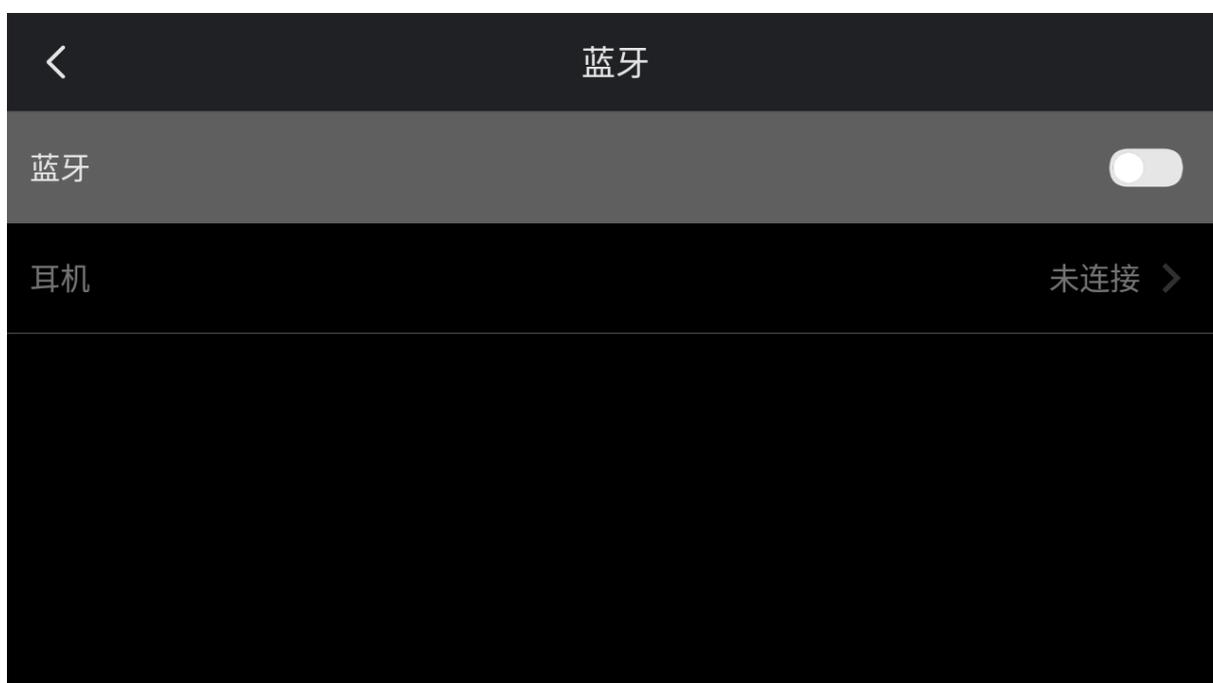
热像仪可以与其它 Bluetooth 设备使用，支持蓝牙耳机连接，添加了支持 Bluetooth 的耳机之后，就可以使用它来添加语音备注。添加支持 Bluetooth 的耳机将自动禁用内置麦克风和扬声器。
