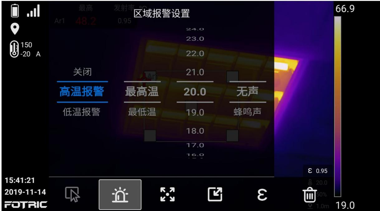
高温报警：当所设置标识温度高于预设的高温阈值时，温度数值变为红色，可选触发尖锐且急促的蜂鸣声提醒检测人员；
