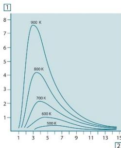
根据普朗克公式绘制各种温度下的图形，可得到一系列的曲线。在任意一条普朗克曲线上， $\lambda = 0$  处的光谱辐射率为零，当波长为 $\lambda_{\text{max}}$  时，光谱辐射率迅速增大到最大值，此后在长波长处又趋近于零。温度越高，则出现最大值的波长越短。
