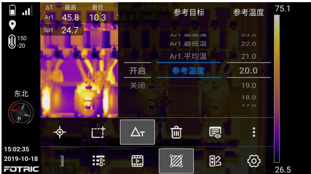
2. 测温 ROI 标识与参考温度差值，如所有温度减 20°C，将参考目标选择为参考目标，考温度设置为 20.0。这时画面中所显示的温度都为实际温度减 20°C，可用于排除环境干扰，计算温升。
