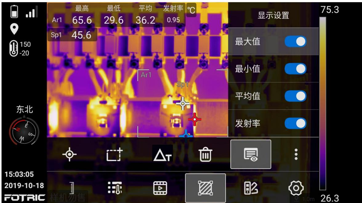
可设置结果显示区 ROI 标识显示内容，最大值、最小值、平均值、发射率。
